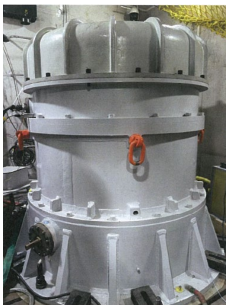
图 1 3 MW/10 kWh 飞轮储能本体
